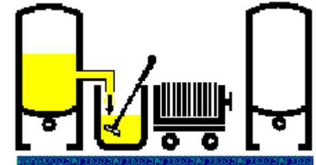
3. Nachdem  $\text{CO}_2$ -Entbindung abgeschlossen, muss eine vollständige Kristallabtrennung erfolgen (am besten durch Filtration).
